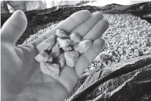
破碎され、用途に応じた規定粒度へ選別されたスーパーソル
