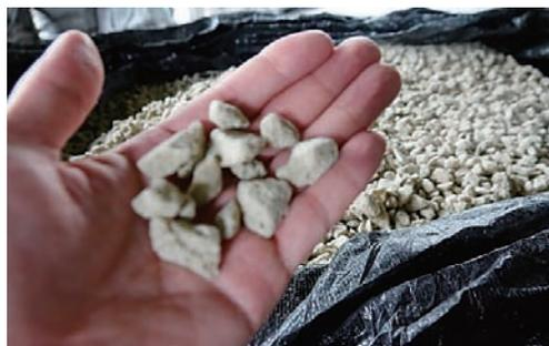
破砕され、用途に応じた規定粒度へ選別されたスーパーソル
